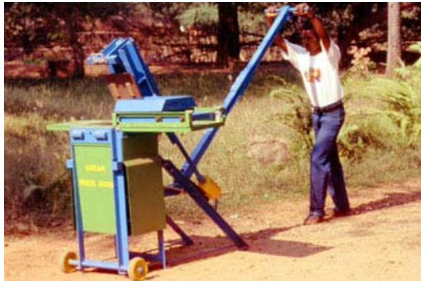
Auram press 3000 - Multimould press (17 moulds)
